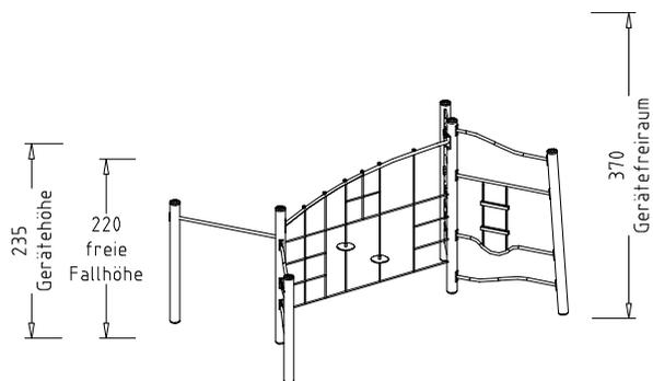
Beschreibung: 6 Standpfosten, 1 Bergsteiger-Kletterwand senkrecht, 7 Edelstahl-Sprossen mit Flansch, teilweise gebogen, 1 Reckstange in Edelstahl, 1 Herkules-Netz senkrecht, mit gebogenem Querträger aus Edelstahl-Rohr, Netz mit unregelmäßiger Teilung sowie 2 integrierten Discs.
