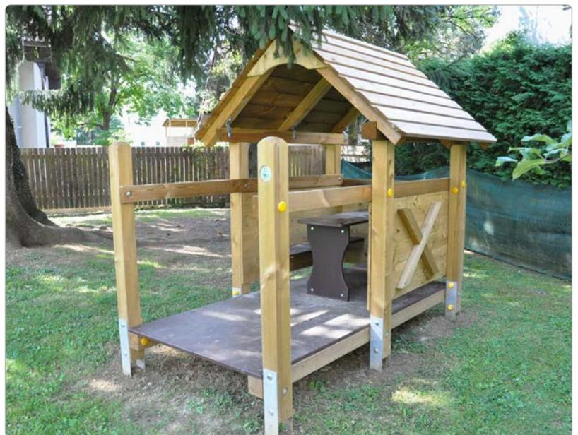
Beschreibung: 6 Steher (Pfosten), aus Kanthölzern 9/9 cm, 2 Unterzüge aus Kanthölzern 9/9 cm, 3 Handläufe aus Kanthölzern 3/9 cm, 2 Brüstungen aus Schichtholzplatte, mit Aussteifungskreuzen, 1 Kaufmannsladen aus Schichtholzplatte, 1 Podest aus Siebdruckplatte, 1 Giebeldach, Einrichtung mit 1 Tisch und 2 Bänken, aus Siebdruckplatte.
