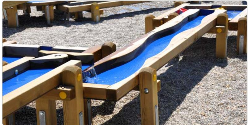
Beschreibung: 4 Steher (Pfosten) 9/9 cm, Beckenwände aus Kanthölzern 7/13 cm, Rinnenboden aus HPL-Platte, 8 mm stark, Farbe blau, 1 Wassersperre, an Edelstahl-Kettenstück.
