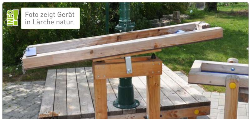
Beschreibung: 2 Steher (Pfosten) 9/9 cm, Beckenränder aus Kanthölzern 7/7 cm, Rinnenboden aus HPL-Platte 8 mm stark, Farbe blau, 2 Wassersperren an den Stirnseiten der Rinne. Gleitlager im Lagerbock, U-Eisen an der Unterseite der Wippe, mit Achse, 2 Gummikegel als Stoßdämpfer, Lagerbock aus Kanthölzern 9/9 cm und 4/11 cm.
