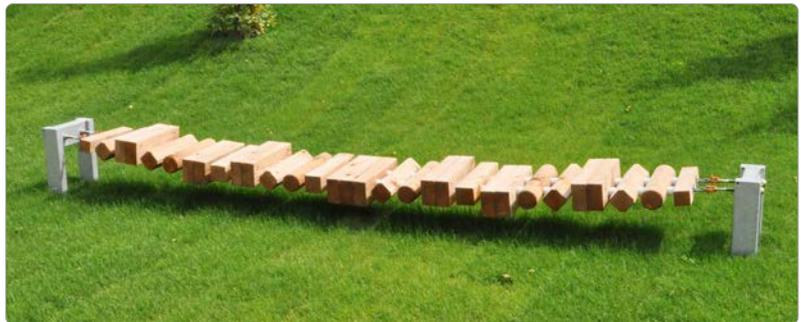
Beschreibung: Kant- und Rundhölzer, werden auf 2 Längsketten 6mm, feuerverzinkt, dazwischen Distanzen, aufgefädelt. 2 Stk. Verankerungssteher (-pfosten) 11/11 cm an beiden Enden, mit Spannvorrichtung. Durch die ausmittigen Bohrungen der Balancierhölzer bietet sich Kindern beim Überqueren eine unebene Balancierstrecke dar. Durch die Asymmetrie und die unterschiedlichen Höhen bleibt die Herausforderung auch nach mehrmaligem Benützen erhalten.
