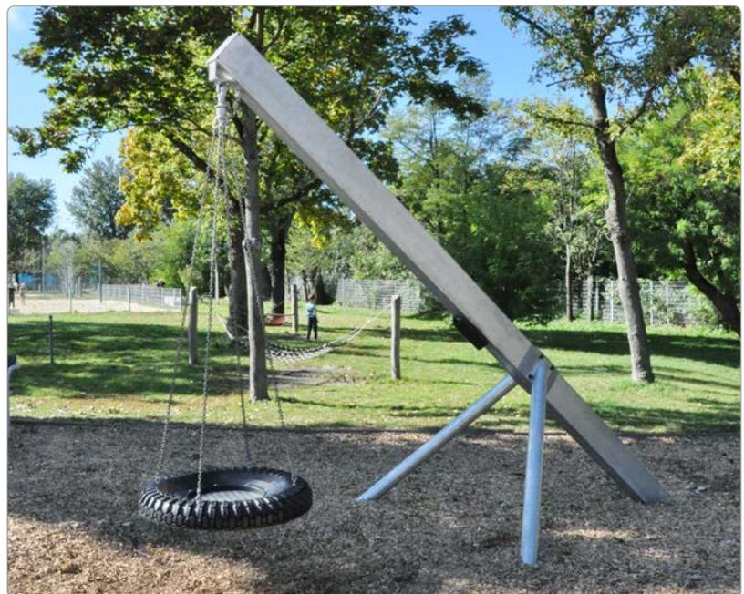
Beschreibung: 1 Schaukelbalken aus Stahl-Reckteckrohr ca. 15/25 cm, 2 Stützen aus Stahlrohr, mit angeschweißtem Flansch, verschraubt, 1 Reifenpendel drehbar, mit Kreuzgelenk und Axialkugellagerung, an 4 Ketten 7 mm, 1 Sicherheitskette.
