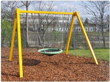
Beschreibung: Schaukelstützen aus Stahl-Formrohr 100/100/4 mm, verzinkt, Schaukelbalken aus Stahl-Formrohr 100/100/4 mm, 3,0 m, verzinkt, mit angeschweißten Flanschplatten zur Montage der Schaukel-Lager, Pendel-Kugellager, mit trapezförmigen Flanschen zur Verschraubung an den Schaukelstützen. 1 Schaukelkorb Ø 120 cm aus Gummigeflecht, mit Stoßdämpfung an den Stahlrohren, Original Vogelnest, an 4 Stk. Ketten, feuerverzinkt, 2 Sicherheitsketten. Fundamente: 4 Stk. 50x50x50 cm
