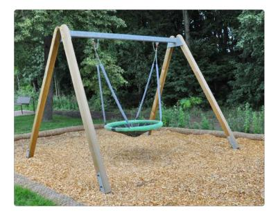
Beschreibung: 4 Schrägstützen aus KH 11/11 cm, 1 Schaukelbalken 3,0 m aus Stahlrohr 100/100/4 mm, verzinkt, mit Flanschplatten 8 mm für die Stützen, 2 Pendelkugellager, schräg am Schaukelbalken befestigt, 2 Abhängungen aus 4 Stk. Ketten 7mm, feuerverzinkt, 2 Sicherheitsketten, 1 Original Vogelnest Ø 120 cm aus Gummigeflecht, mit Stoßdämpfung an den Stahlrohren. Aufständerung mit 4 Stk. Doppellaschen.
