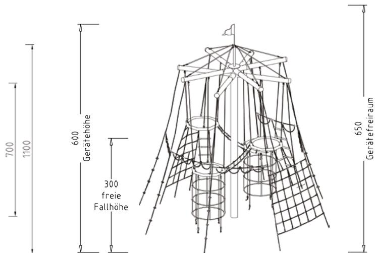
Beschreibung: 1 Stahlmast, feuerverzinkt, mit angeschweißten Kragarm-Hülsen, zur Aufnahme von 6 Querhölzern, aus lasierten, wasserfest verleimten Rundhölzern, 4 Vogelnester mit Verbindungsleitern, mit 3 Sprossen, 2 Aufstiegsnetze, 5 Klettertaue mit Kletterhilfen, 2 Kletterkamine, mehrere Girlanden- und Hangelseile.
