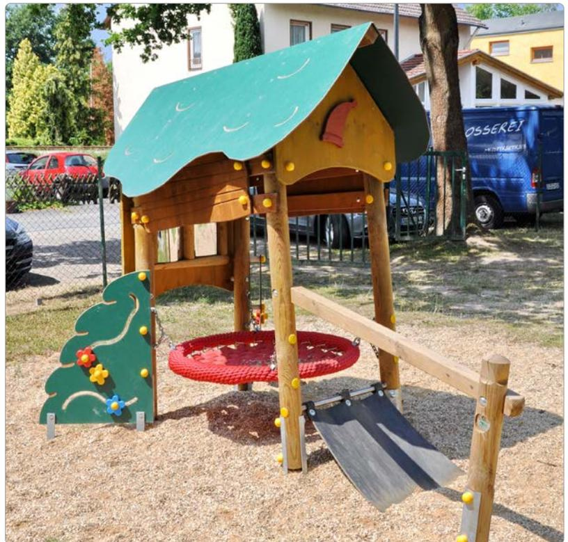
Beschreibung: 5 Steher (Pfosten), aus Rundhölzern Ø 10 cm, 4 Brüstungen aus Schichtholzplatte, färbig lasiert, 1 Brüstung mit Zerrspiegeln ausgestattet, 1 Dach aus HPL-Platte mit Intaglio-Fräsungen, 2 Motorik-Paneele in Busch-Form, aus HPL, 1 Nest-Korb mit Gurtgeflecht, an 4 Ketten aufgehängt, 1 Rampe aus Gummigurt mit Gewebeeinlage, 1 Kantholz-Handlauf 7/7 cm.
