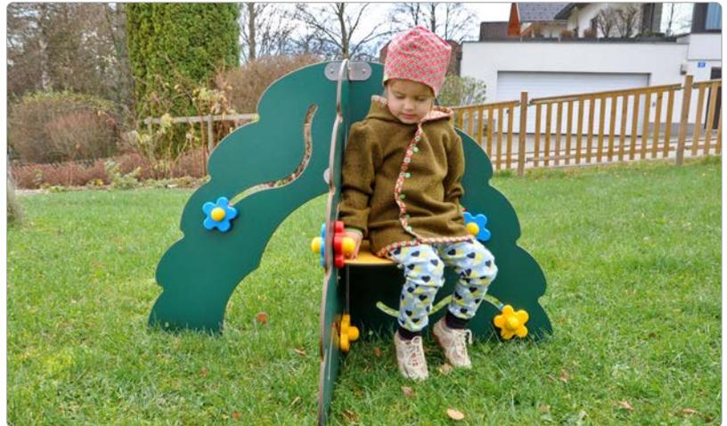
Beschreibung: Der Zauberbusch ist eine Kombination aus Motorikpaneel, Sitzbank und Schlupfloch. 4 HPL-Platten, 8 mm, grün mit verschiebbaren und drehbaren Früchten aus PE-Platte, 6 mm, 1 Platte mit Schlupfloch, mit Edelstahl-Winkeln verschraubt, 1 Sitzbank, HPL-Platte 6 mm.
